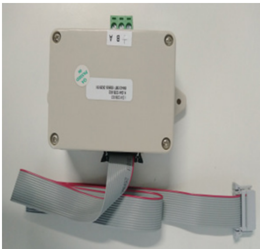
图 16 RS485 联网接口模块及其连接排线
