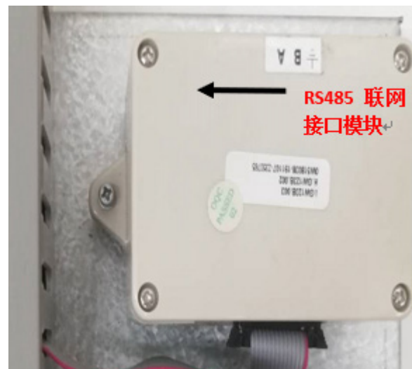
图 7 RS485 联网接口模块安装后实物图
