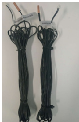
图 15 系统出水 / 回水温度传感器
